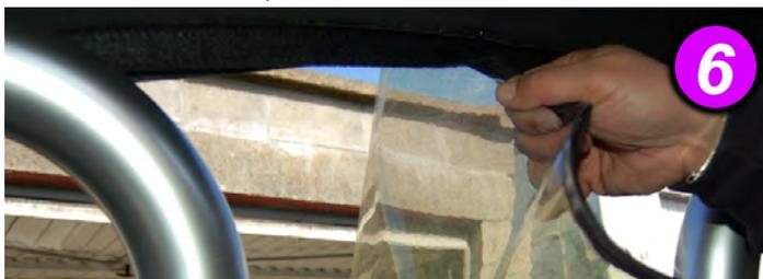
Nettoyez l'adhésif restant sur la capote (flèche verte) puis dégraissez la surface (avec de l'acétone) de façon à obtenir une surface lisse :
