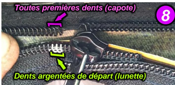
Ecarter l'agrafe à l'aide d'un tournevis plat et d'une pince puis rebloquez-la sur la fermeture éclair comme le montage d'origine :
